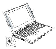
b) **Fn + Home** または **Fn + End** でLCD の輝度を調節します。
