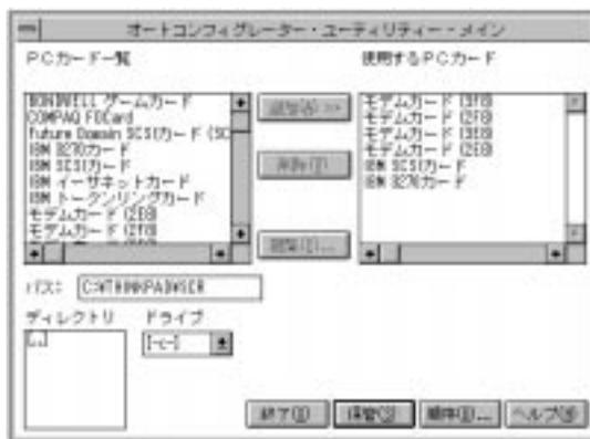
優先的に資源を割り当てたいカードを先に選択するようにします。たとえば、モデム・カードに COM2 ではなく COM3 を割り当てたい場合は、COM3 の設定を最初に選択します。
